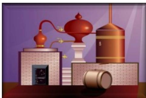
La distillation discontinue ou double distillation dite également « à repasse » : c'est la distillation charentaise consacrée par les usages locaux, loyaux et constants, obligatoire pour l'obtention des eaux-de-vie de Cognac. Elle s'effectue en deux chauffes successives au moyen d'un alambic dit « charentais » qui est resté très artisanal.
